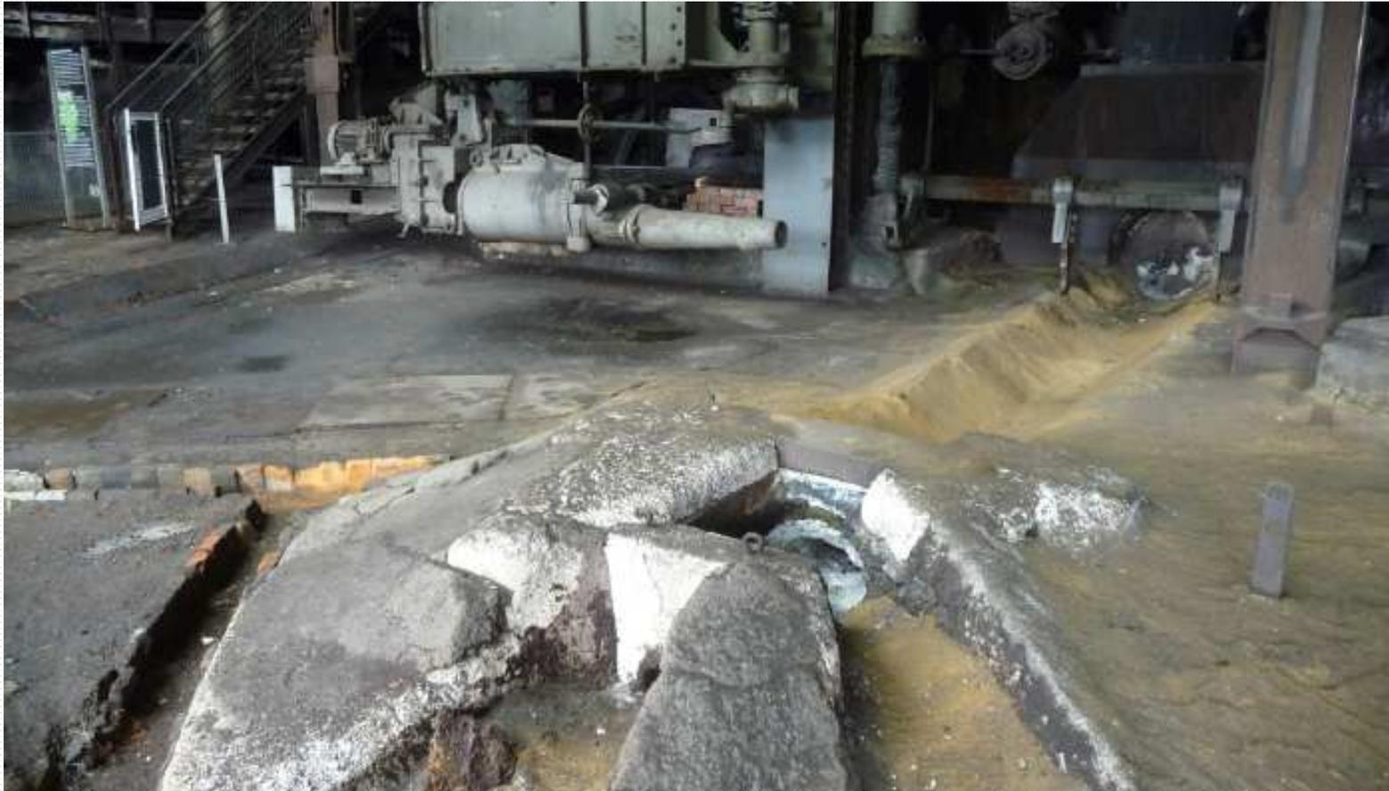
– Chemin de coulée en sortie de creuset d'un haut-fourneau –
