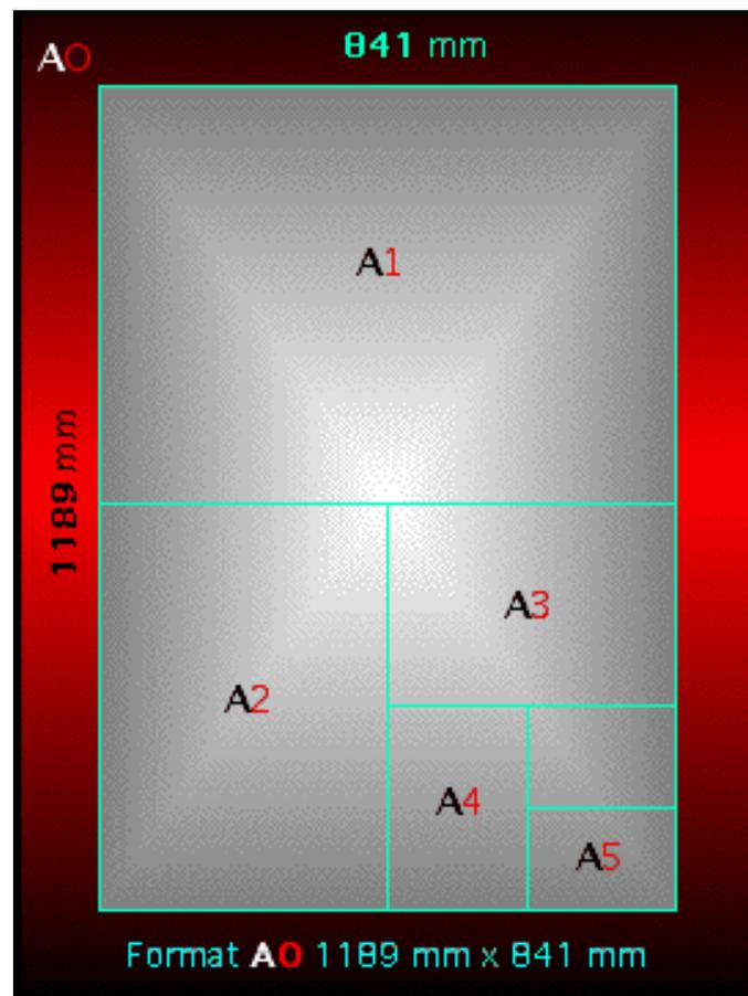
Le calcul du format papier **ISO A0** se fait en théorie à partir d'une surface de 1000 mm x 1000 mm soit 1m<sup>2</sup>. Le pliage des formats **A1**, **A2**, **A3**, **A4** et **A5** s'effectue à partir de la même surface théorique mais rapportée à un format de **1189** mm x **841** mm.
