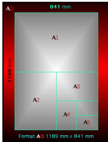
Le calcul du format papier **ISO A0** se fait en théorie à partir d'une surface de 1000 mm x 1000 mm soit 1m<sup>2</sup>. Le pliage des formats **A1**, **A2**, **A3**, **A4** et **A5** s'effectue à partir de la même surface théorique mais rapportée à un format de **1189 mm x 841 mm**.
