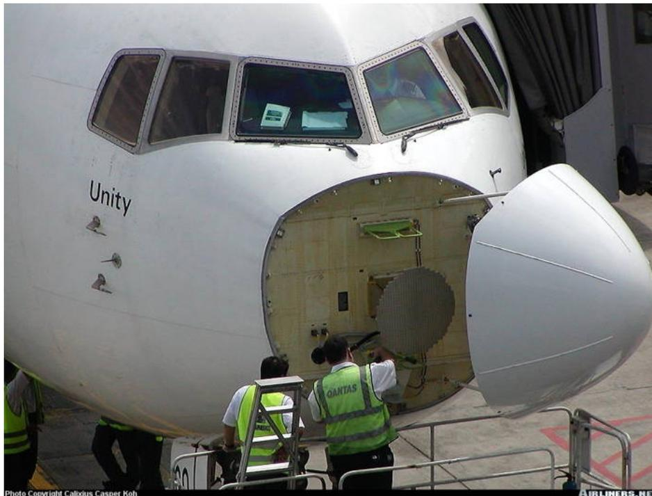
Maintenance de l'instrumentation radar cachée derrière un nez d'avion
