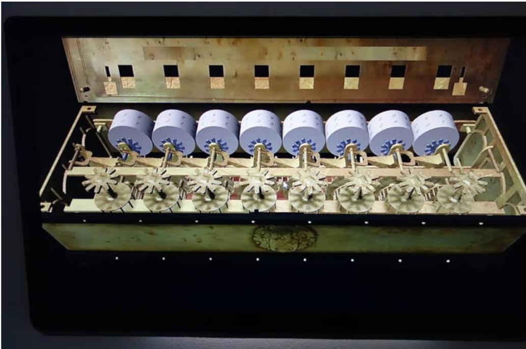
"Machine à calculer" ou "Pascaline" de Blaise Pascal – modèle à 8 roues fermé et ouvert
